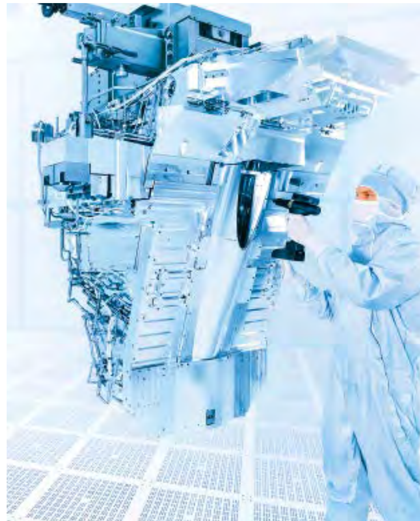
Hochpräzise im Reinraum: Der Spezialbelichter für Halbleiter von Carl Zeiss besteht aus 15.000 Teilen und wiegt 1,5 Tonnen. Die Firma erhielt den Mittelstandspreis 2023.
